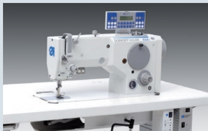
Dürkopp Adler 525 - Zickzack-Schnellnäher mit Untertransport und großem Greifer um Kante an Kante zu nähen
