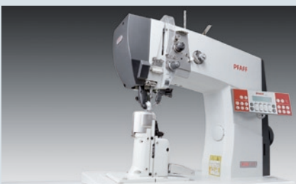
PFAFF 571/574/591-725 - Mechanische Ein- und Zweinadel-Säulenmaschine mit Unterschneideinrichtung
