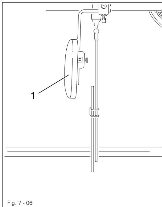
● Durch Betätigen des Kniehebels 1 wird der Nähfuß angehoben.
